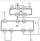
Connection with safety modules CS AT-0 •••• / CS AT-1 •••••
